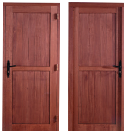
Modèle exotique. Cadre 32 mm , remplissage frises verticales pas de 27 mm , ferrage par paumelles, poignée fournie, option serrure 3 points encastrée.
