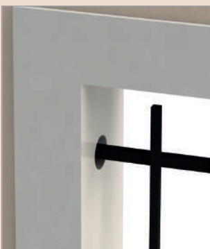
Scellement en tableau (standard)
