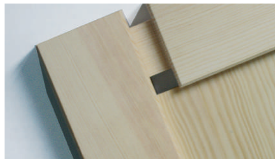
Assemblage par tenon et mortaise
